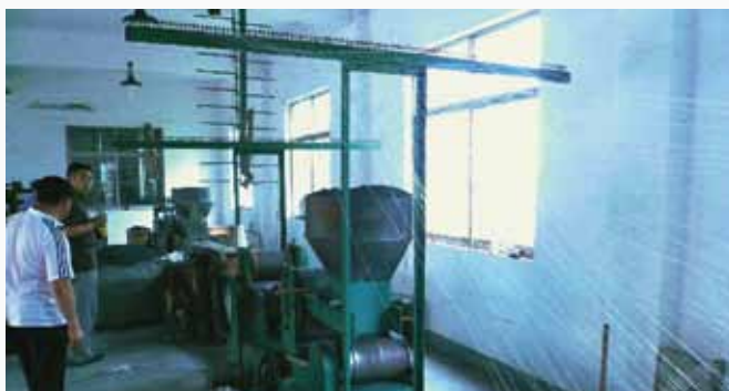
Рис. 5. Линия прокатки армированной графитовой фольги (китайское производство)
